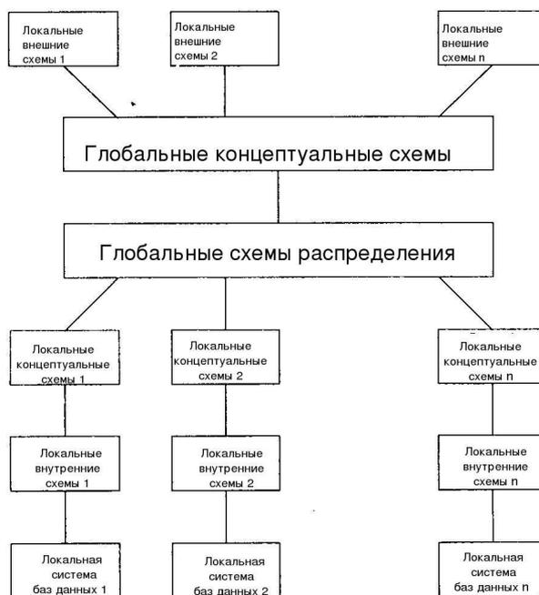
Рис. 1. Обобщение трехуровневой архитектуры на случай распределенной схемы.
